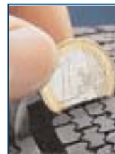
Schnell-Check: Deckt das Profil den Rand der Euromünze nicht mehr ab, steht ein Wechsel an.
