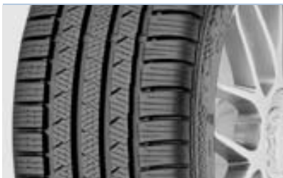
Notlaufreifen: Dunlop Winter Sport M3 DSS1, der auch bei Luftverlust weiter fährt.
